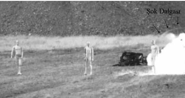
Şekil 5. 1000 gr C4 ile oluşan şok dalgası.
