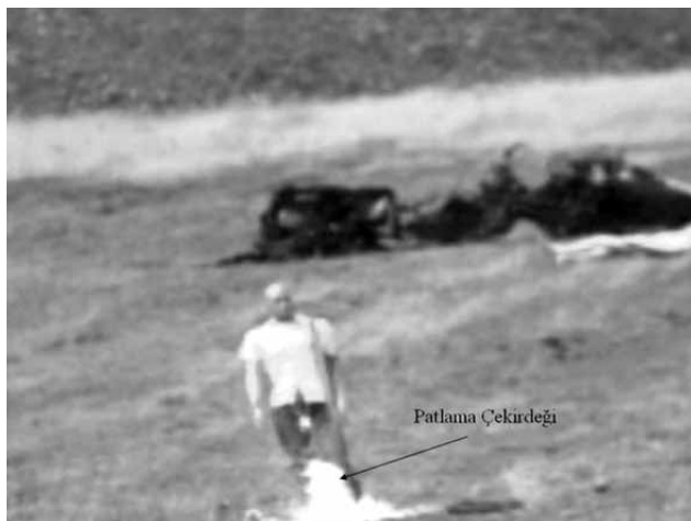
Şekil 1. 100 gr TNT patlaması ile oluşan patlama çekirdeği.
